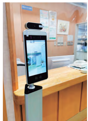
図5 当院玄関に設置した赤外線サーモグラフィカメラ
